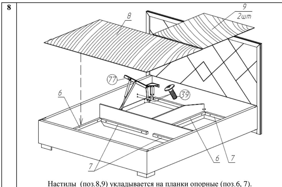
Настилы (поз.8,9) укладывается на планки опорные (поз.6, 7).
